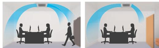
Climatizzazione confortevole evitando flussi diretti d'aria e variando in continuo la posizione delle alette (swing).
